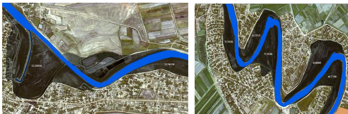
Рис. 1 Моделирование риска затопления по разновременной космической информации. Чёрные контуры прогноза по информации 2010 года наложены на снимок 2016 года.
